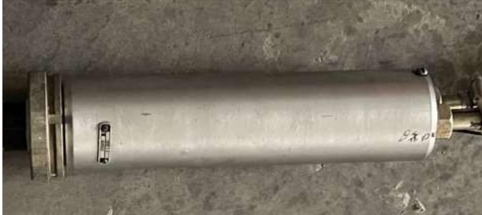
Рис. 3.6. Магнитострикционный преобразователь ПМС 1-1
