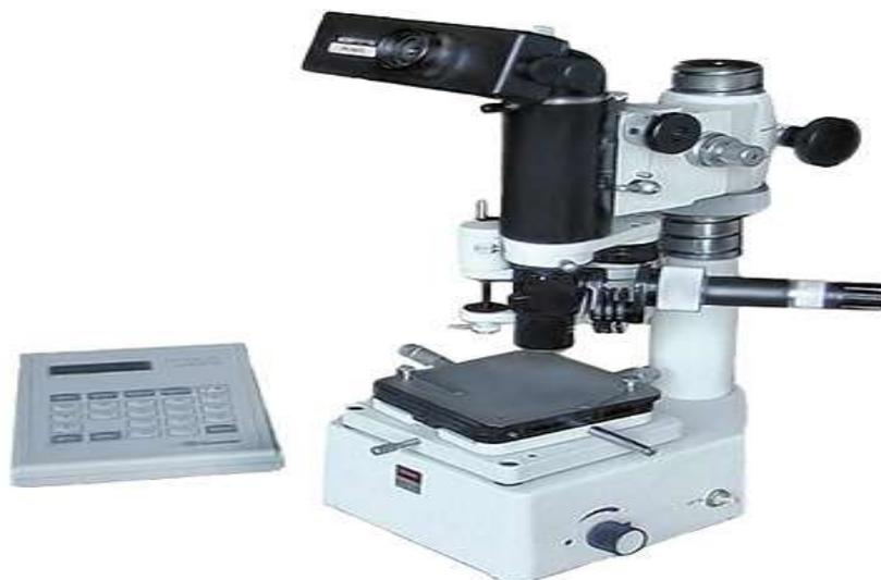
Рис. 3.11. Прибор для измерения микротвердости ПМТ-3М
