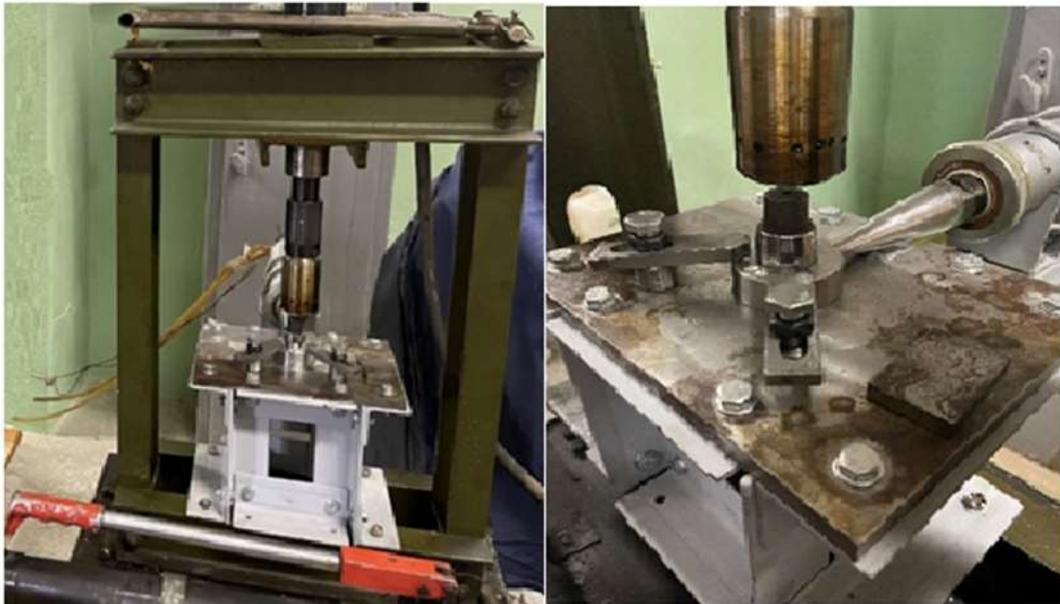
Рис. 3.5. Специальное приспособление для установки образцов в сборе с преобразователем и концентратором УЗК
