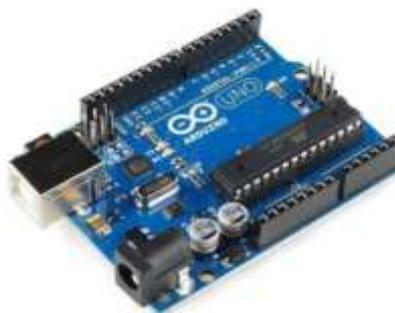
Рис. 4.5. Плата Arduino Uno R3
