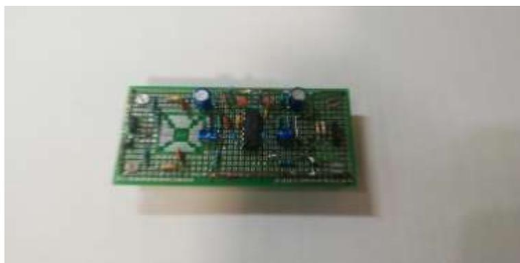
Рис. 4.4. Плата усилителя сигнала
